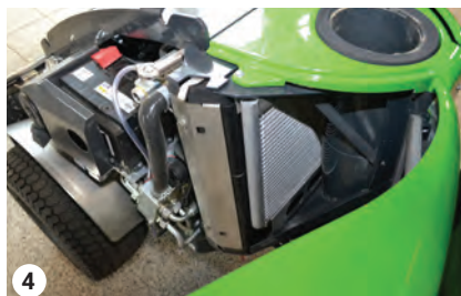
4 Vyčistěte chladič pomocí stlačeného vzduchu
