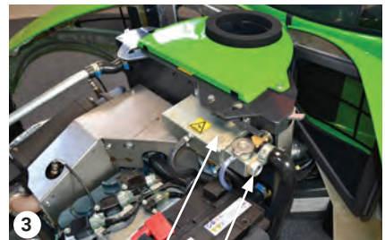
Vyrovnávací nádrž – zkontrolujte hladinu chladicí kapaliny
